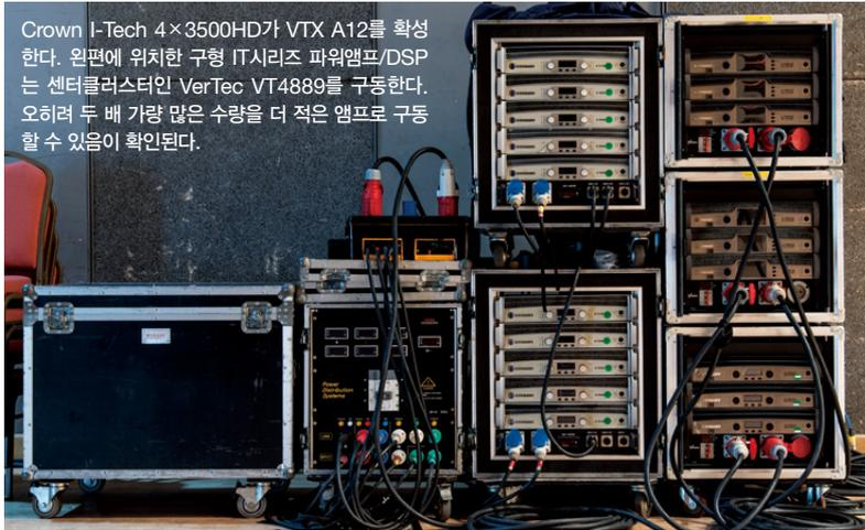
Crown I-Tech 4×3500HD가 VTX A12를 확장한다. 왼편에 위치한 구형 IT시리즈 파워앰프/DSP는 센터클러스터인 VerTec VT4889를 구동한다. 오히려 두 배 가량 많은 수량을 더 적은 앰프로 구동할 수 있음이 확인된다.
